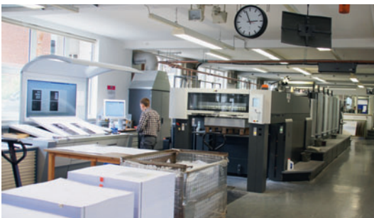
Sowohl im Offsetdruck ist Heidelberg bis zum Format 72 x 102 cm mit der fünffarbigen Speedmaster CX 102 plus Lackwerk bei Pinkvoss im Drucksaal vertreten, als auch in unmittelbarer Nähe zur neuen Falzmaschine durch einen Tiegel und einen Zylinder für Nut- und Stanzarbeiten. Dabei ist die Abstimmung zwischen den Maschinen perfekt.
